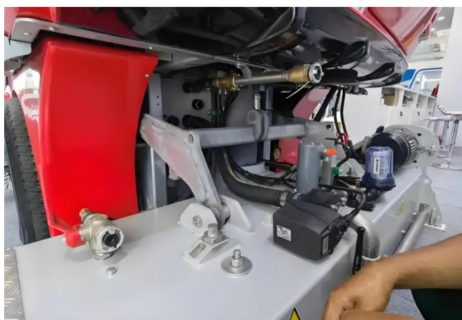
图5 浇冰车冰面清理装置外观图
